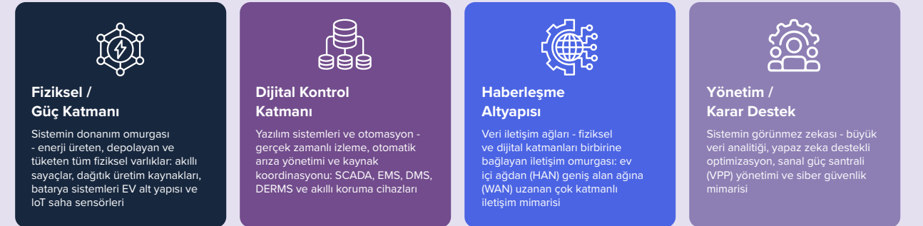
Şekil 8. Akıllı Şebekenin Katmanlı Yapısına Genel Bakış
